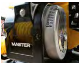
Em caso de notável variação da altitude, pode facilmente regular o ar da combustão
