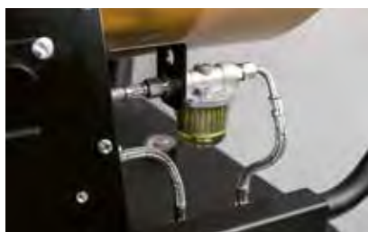
Pré-aquecedor de combustível opcional, filtro de combustível exterior
