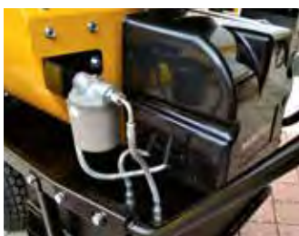
O filtro de combustível está no exterior. O queimador está equipado com pré-aquecedor de combustível
