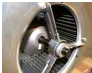
Ventilador centrífugo potente, baixo nível sonoro de 72 dB (A)
