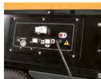
Painel de controlo com conector para termóstato remoto opcional (analógico ou digital)
